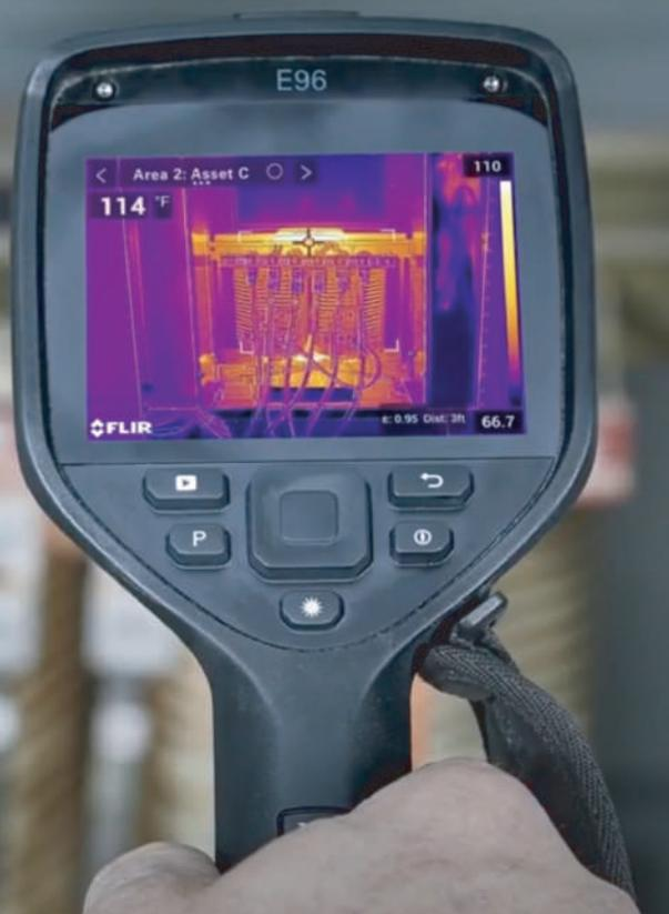
La prova può essere eseguita solamente mediante utilizzo di apposita strumentazione. Il caso più frequente è quello dell'utilizzo di una termocamera a infrarossi che consente di rilevare i valori di temperatura anomali, siano essi assoluti o relativi, sui diversi elementi dell'impianto senza ricorrere a prove distruttive.
